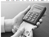
同社のクレジットカードは実証実験の指紋認証専用ICカードを採用している（提供）
